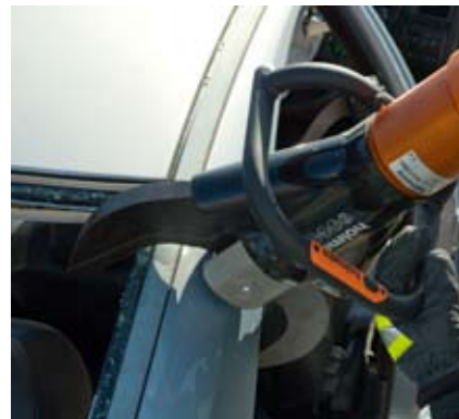
Große Messeröffnung von 202 mm umschließt die breitesten C-Säulen.
