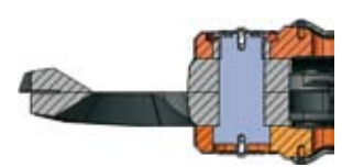
Drückt die Messer direkt zusammen für eine hervorragende Schneidleistung.
