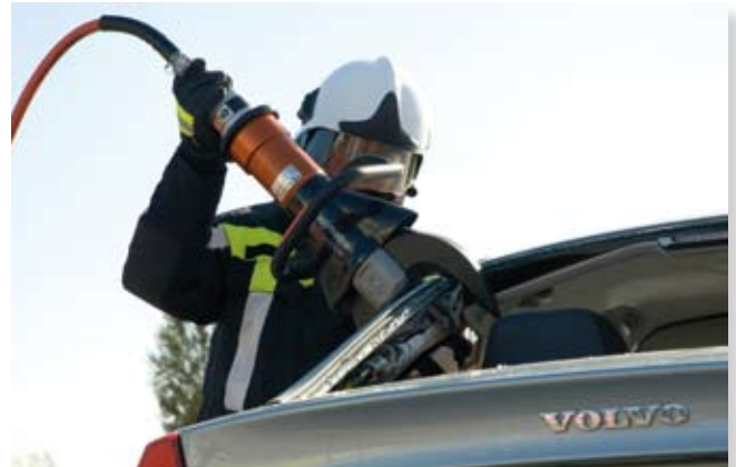
Das CU 4055 C NCT™ II ist ausführlich an den breiten A-, B- und C-Säulen der neuesten Automodelle getestet worden.
