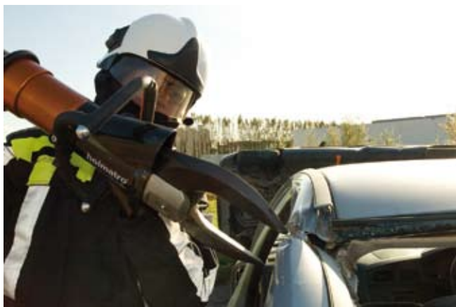
Breite Volvo C-Säule, die mit einem CU 4055 C NCT™ II geschnitten wird.
