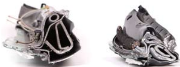
Querschnitt einer A-Säule eines neuen Saab 9-3 Cabrio vor und nach dem Schneiden.
