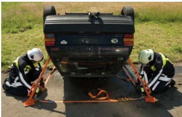
Stabilisierung eines auf dem Dach liegenden Fahrzeugs mit zwei kürzeren VS 7 Stützen.
