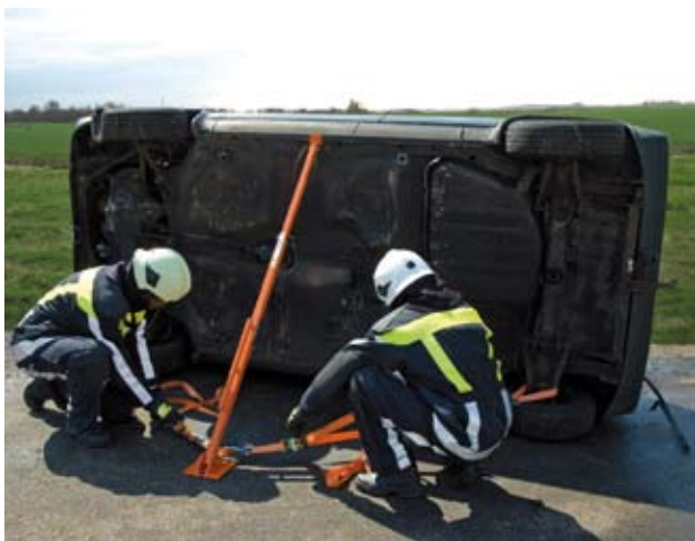
Stabilisierung eines Fahrzeugs in Seitenlage mit einer einfachen langen VS 13 Stütze.
